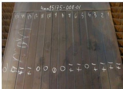
Рисунок 15 – Результаты порезки листа толщиной 4 мм и шириной 1500 мм на установке плазменной резки
